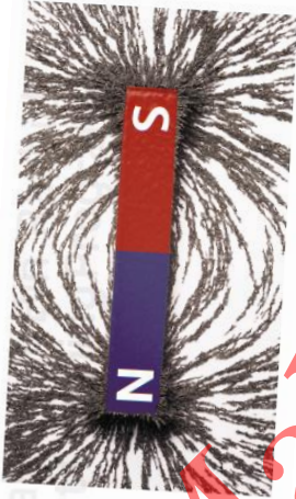
الشكل 14 يمكن إظهار مجال مغناطيسي غير مرئي بنثر برادة الحديد عليه.
