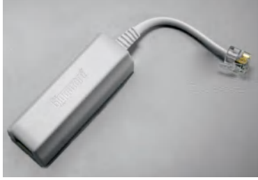
الشكل 10.21 مرشح إمرار نطاقي نموذجي للهواتف التي توصل بدائرة منزلية فيها اتصال إنترنت DSL.
