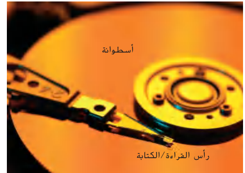
الشكل 9.31 رأس القراءة/الكتابة وأسطوانة دوران داخل محرك القرص الصلب بالكمبيوتر.
