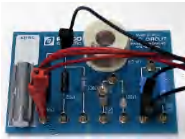
الشكل 10.18 دائرة موصولة على التوالي تحتوي على محث معامل حثه 8.2 mH ومقاوم قوته 10 \Omega ومكثف سعته 100 \mu F.
