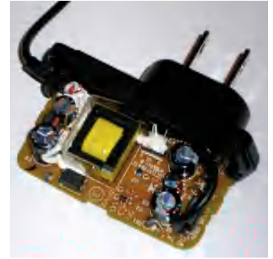
الشكل 10.33 المحوّل (الأصفر) ذو القلب (الأصفر) هو المكوّن الرئيس لشاحن الهاتف الخلوي. (يحتوي الشاحن أيضًا على مقوّم، كما موضح في القسم 10.8).
